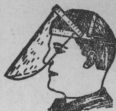
图17 防护铁屑用的防护面罩。
