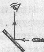
圖 17 水下觀測筒中 光線進行路程
