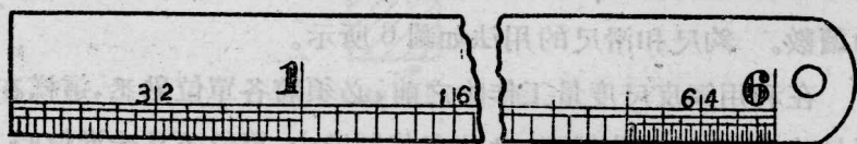
圖 5 鋼皮尺的英制刻線
