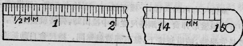
圖 4 鋼皮尺的公制刻線
