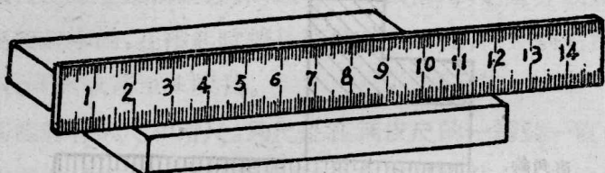
圖 7 鋼皮尺度量工作物長度圖
