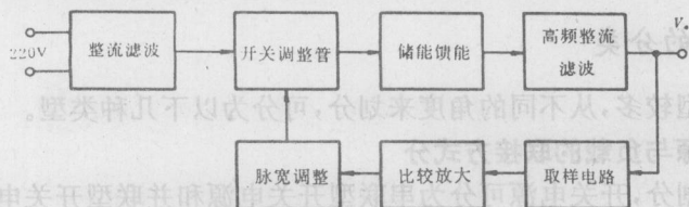
图 1—1 开关稳压电源基本电路原理方框图
