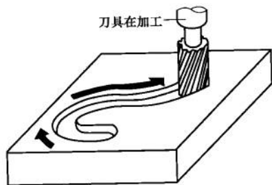
图 1-3 轮廓控制系统加工示意
