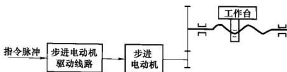
图 1-4 开环控制数控机床的系统框图
