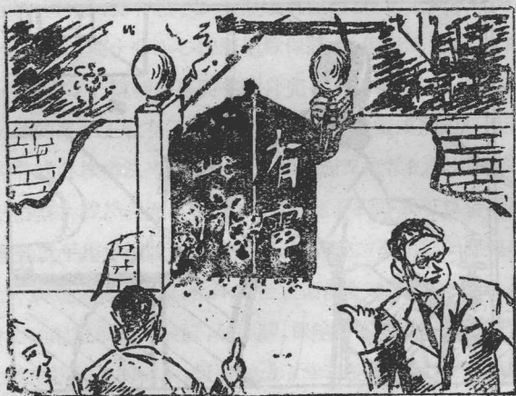
圖二 門燈漏電到鐵門上，鐵門和地間有相當的電阻，也有相當的電壓，於是此門有電。
