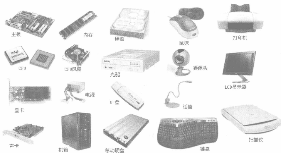
图 1-2 微型计算机的主要组成部件
