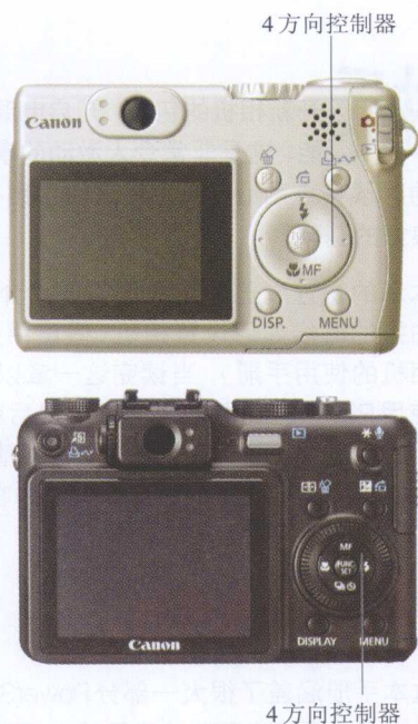
图 0.1 两种不同类型的4方向控制器的例子，可能看到其他和这两种都不同的，但是功能上大部分都相同
