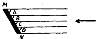
图1 平行的太阳光綫射到平面上所成的入射角处处相等（ A = B = C = D ）。
