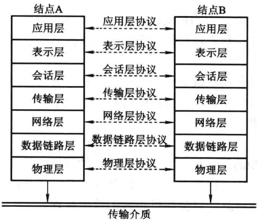
图 1-11 OSI 参考模型对等层通信结构图
