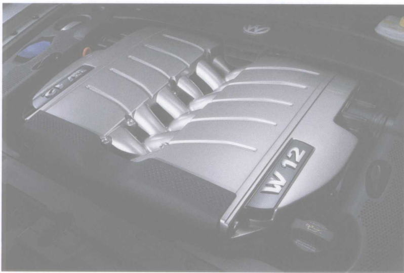
大众W12发动机是由两台VR6发动机以72°夹角结合而成
