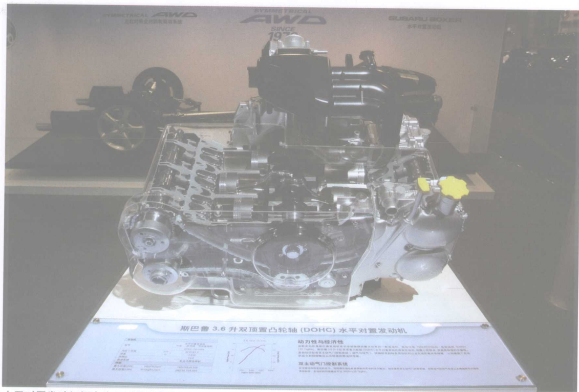
水平对置发动机拥有水平对置的活塞
