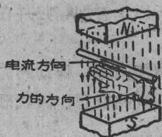
图1—2 用左手定则确定导线受力的方向
