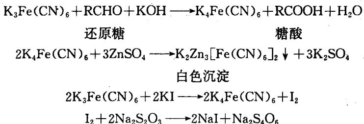
在上述反应中试样的还原糖含量多时,剩余的铁氰化钾就少,析出的游离碘也少,则滴定时消耗的硫代硫酸钠的量也少。由此可见,还原糖含量与硫代硫酸钠溶液用量成反比关系。但这种关系还不能完全根据反应式进行计算,而只能根据氧化还原糖时所用去的一定浓度的铁氰化钾溶液的毫升数查经验数据求得。
