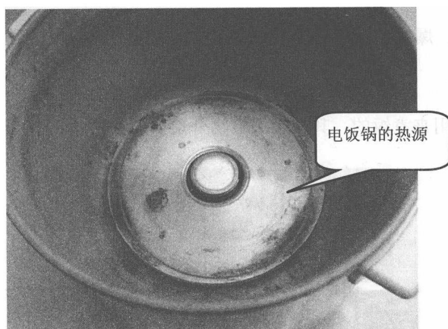
图1-5 保温式电饭锅的加热器
