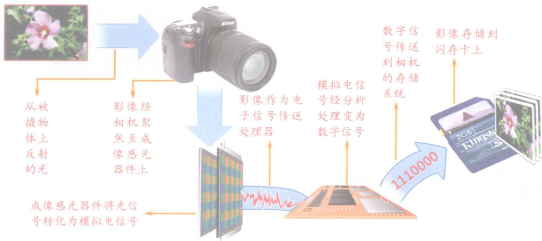
图1-6 数码相机的工作原理
