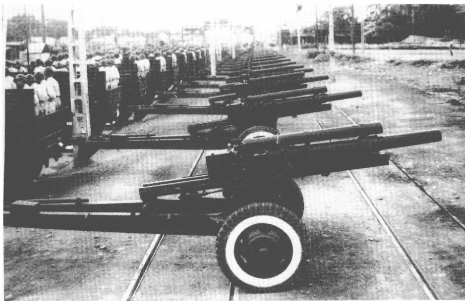
■ 受阅的美国造 M2A1 式 105 毫米榴弹炮。解放战争中缴获。口径 105 毫米，最大射程 11270 米，持续射速 3 发 / 分
