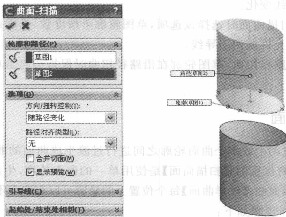
图 1-9 【曲面-扫描】属性管理器及扫描曲面过程
