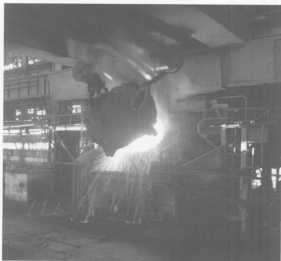
150吨氧气顶吹转炉
