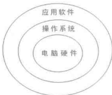
图 1-13 电脑硬件、操作系统和应用软件三者的关系
