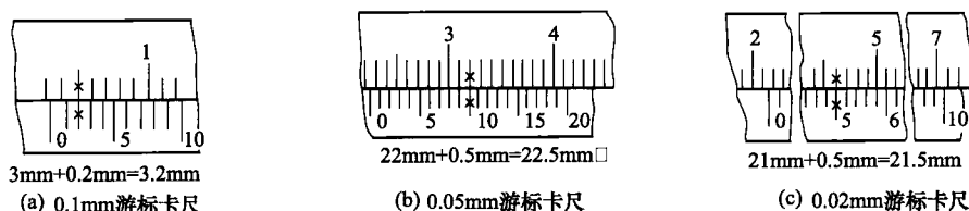
图 1-4 游标卡尺的读数方法
