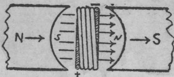
圖 1-3 磁通方向一致後線圈停留不動。
