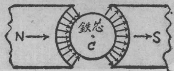
圖 1-4 軟鐵柱芯把空隙磁通集中起來。
