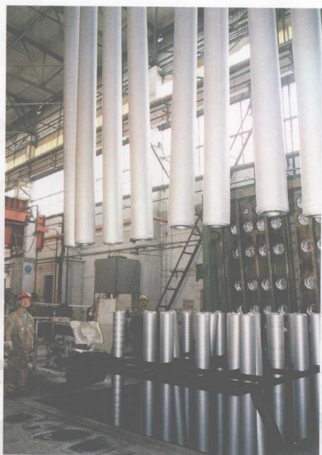
生产6063铝合金圆棒的气幕铸造 生产线 (张旭东摄)
