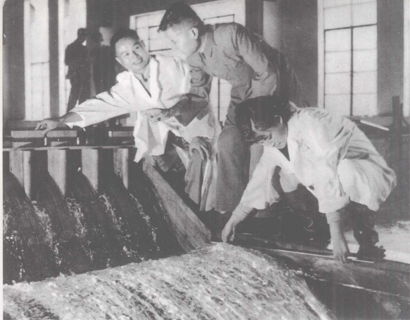
设计与科研工作者进行水工模型试验
