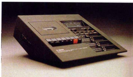
彩图-13 意大利设计师贝里尼1975年为雅马哈公司设计的“TC800”型卡式录音座采用了楔形造型以方便使用,红色的录音键起到了画龙点睛的作用
