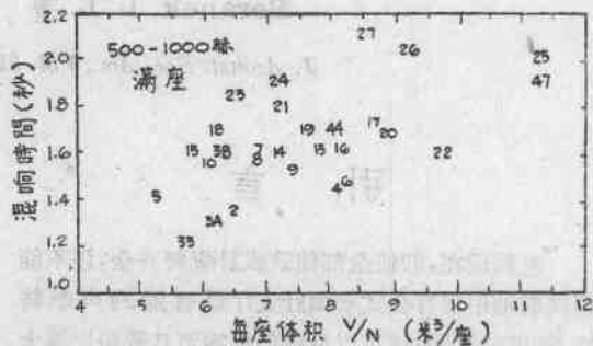
图 1 滿座大厅中中頻 (500~1000 赫) 的混响时间对每座体积的图。其中有些大厅是加过少量多孔吸声材料的，但由此而引起混响时间的改变不会超过 0.1 秒。为计算精确起见，这些大厅沒有列入图 2。
