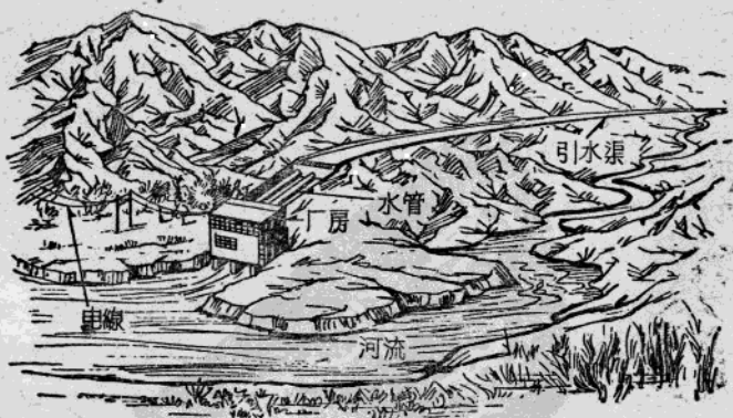
图3 引水渠道式水电站。
