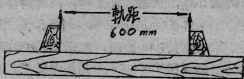
圖6 木質道軌的鋪設
