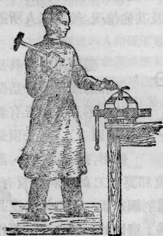
圖 2 鑿削時用肘擊法
