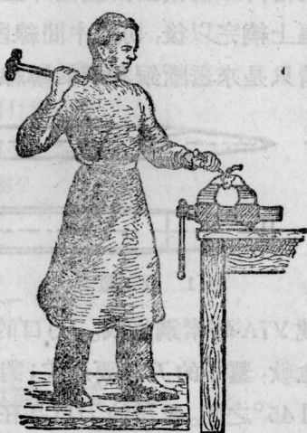
圖 3 鑿削時用臂擊法
