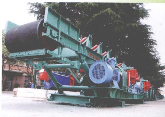
DSJ100/100/2×125 大功率长距离可伸缩皮带机
