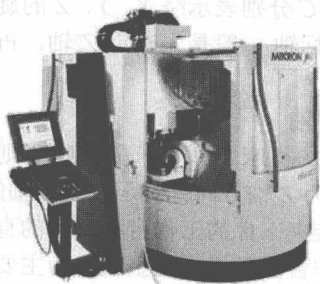
图 1-10 瑞士米克朗 HSM400U 高速五轴加工中心
