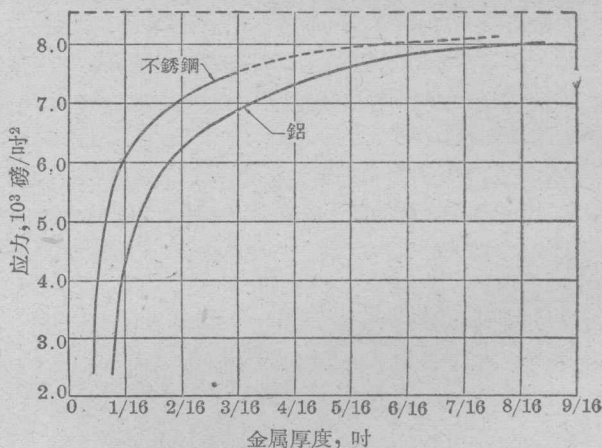
图 10 金属搭接时的强度。采用优质胶粘剂时,被粘物特性对胶接强度的影响
