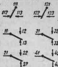
第233圖 KP-1型繼電器接點圖
