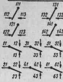
第234圖 KP-2型繼電器接點圖
