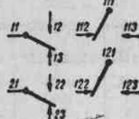
第235圖 KP-3型繼電器接點圖
