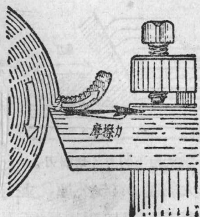
圖4 帶有摩擦力的切屑從切削面向刀子方向推出。
