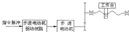
图1-2 开环控制数控机床的系统框图
