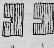
圖 2.7 橫鋸齒鋸割纖維的情形
