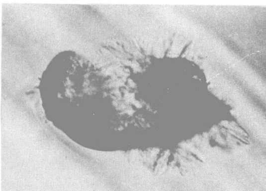
图 28 石英颗粒开裂处转化成树枝状方石英 ( \times 100 )
