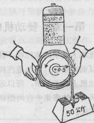
圖 2 拖拉机就是用发动机产生的扭力来工作的。
