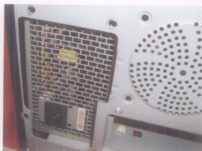
图2 将电源螺丝孔和机箱螺丝孔对齐
