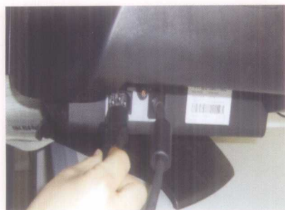
图 46 显示器电源线的连接
