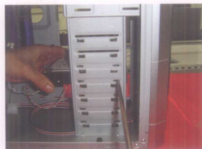
图 31 用螺丝钉固定硬盘
