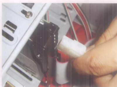
图 39 硬盘电源线的连接
