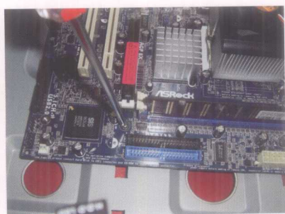
图 16 用螺丝固定主板
