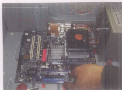
图 15 将主板倾斜放入机箱中
