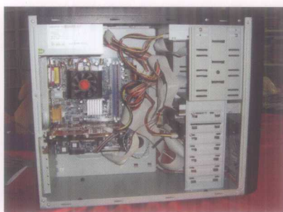
图 41 整理机箱内部连线
