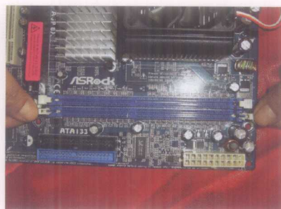
图11 掰开内存插槽两端的卡子
