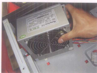
图1 将电源放入机箱的电源固定位
