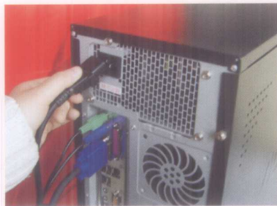
图 47 机箱电源线的连接
