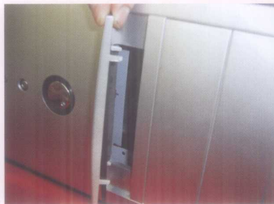
图 26 撬开机箱软驱挡板
