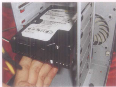
图 29 将硬盘平放入托架
