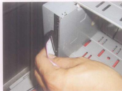
图 32 光驱数据线的连接
