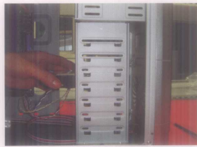
图 30 将硬盘的螺丝孔与托架的螺丝孔对齐
