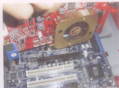
图 21 将显卡插在AGP插槽中
