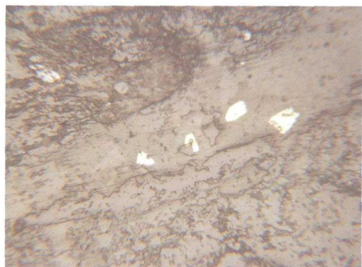
ZK0001-5 取样深度 42m。方解石脉。脉中有黄铜矿、黄铁矿，边缘为磁铁矿。
