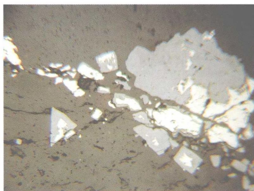
ZK0001 取样深度55m。糜棱岩质碎裂岩。褐铁矿（蓝灰色）交代黄铁矿，残留黄铁矿核。
