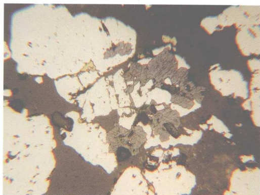
ZK0802 取样深度45m。辉铜矿（灰色，解理发育）、黄铜矿、黄铁矿。
