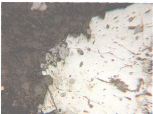
ZK8701 取样深度 55m。黄铁矿局部被磁铁矿交代，磁铁矿晶形较好，六边形、五边形、四边形，麻点状分布于黄铁矿中。
