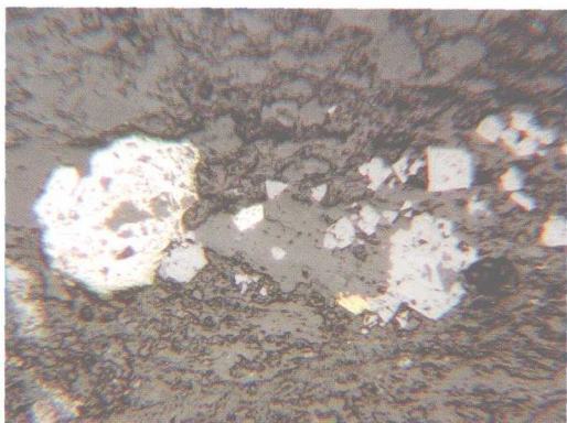
ZK8701 取样深度55m。糜棱岩质碎裂岩。黄铁矿、磁铁矿、黄铜矿集中分布。
