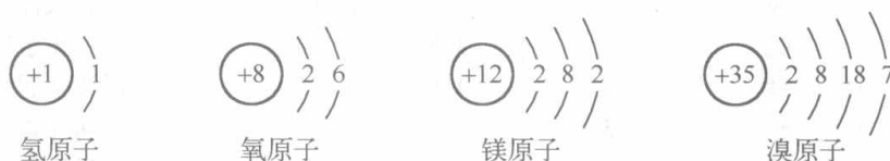
图 1-1 4 种元素的原子结构示意图
