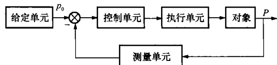
图 1-3 炉膛压力自动控制系统方框图
