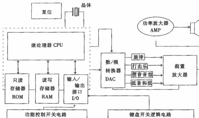
微处理机音源使用超大规模集成电路，内部包括微处理器 CPU、只读存储器 ROM、读写存储器 RAM、输入/输出控制线接口 I/O，在电路内固化了键盘扫描、音阶程序、音色、低音伴奏、自动和弦、琶音、打击乐节奏及编程等功能。这些数据存储在电路内部各地址数据库内，通过不同接口，由键盘和键钮读写输出。微处理器 CPU 通过传送线将数据信息送到数/模转换器 DAC。DAC 是具有波形存储功能的大规模音乐集成电路，将数字信号变为模拟信号。有些电路集成度更高，把音源、微处理器及数/模转换器合在一起，成为一体化的功能更全的电子琴微处理机。
