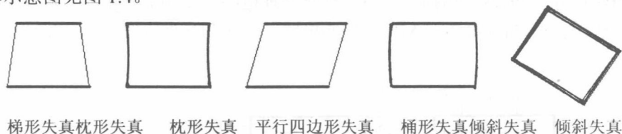
图 1.4 光栅几何失真示意图
