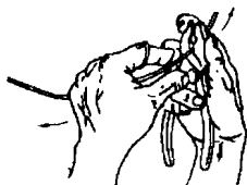
图 1.4 用钢丝钳剖削塑料硬线绝缘层
