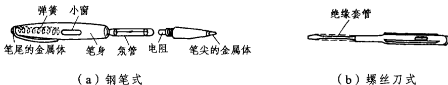
图 1.1 低压验电器结构
