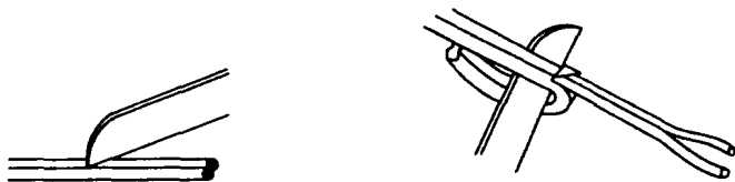
图 1.6 电工刀剖削塑料护套线绝缘层
