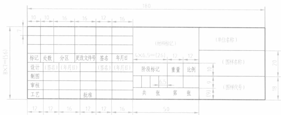
图 1-3 国标规定的标题栏格式
