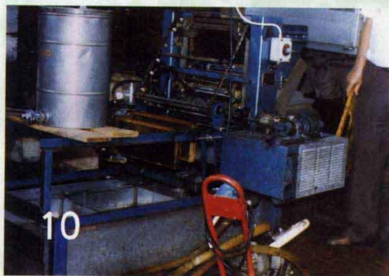
取蜜车间的自动 电热割蜜盖机
