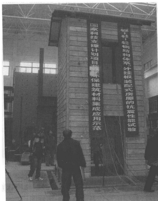
图10 抗震性能试验
