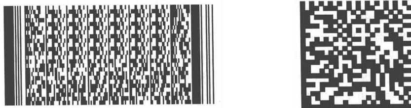
图 1-4 堆叠式与矩阵式二维条码
