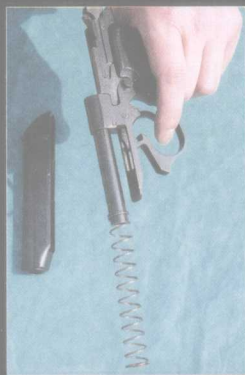
▲64式手枪采用自由枪机原理，枪管固定，枪机和套筒合为一体，射击时借助套筒的综合质量和复进簧的阻力封闭枪管尾部。
