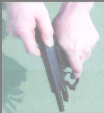
▲64式手枪采用自由枪机原理，枪管固定，枪机和套筒合为一体，射击时借助套筒的综合质量和复进簧的阻力封闭枪管尾部。
