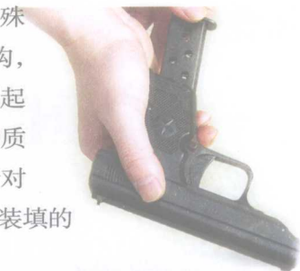
▲中国77式手枪独具特色之处在于设计了一种单手装填机构。
