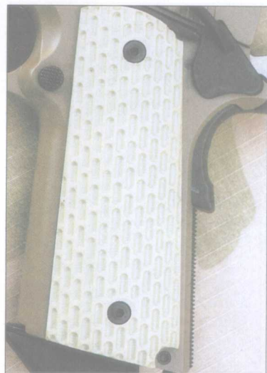
▲M1911手枪沙星色的握把护板上刻有这种形状防滑纹。护板由G-10/FR-4材料制成。
