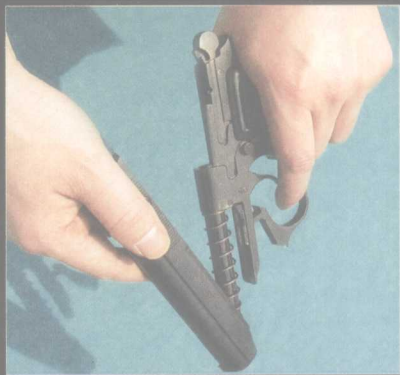
▲64式手枪采用自由枪机原理，枪管固定，枪机和套筒合为一体，射击时借助套筒的综合质量和复进簧的阻力封闭枪管尾部。
