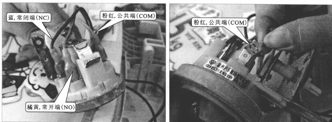
图 1-13 取下水位开关的连接电线
